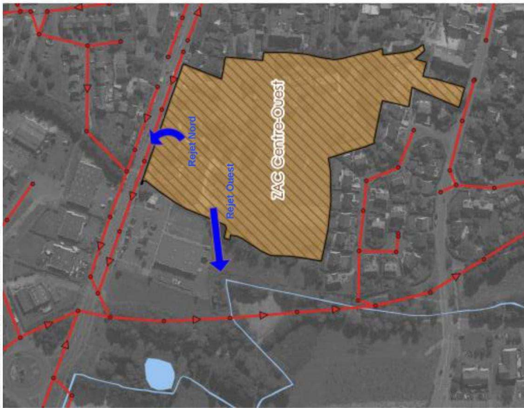
Figure 3-1: exutoires probables de la ZAC Centre-Ouest
